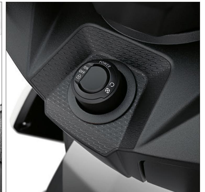
Von links oben nach rechts unten: LED-Scheinwerfer mit optionalem Tagfahrlicht, großes Staufach „Flexcase“. Optional: TFT-Display und Keyless Ride.
